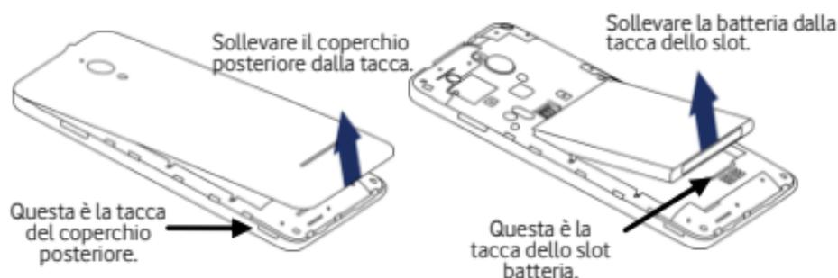
**Rimozione del coperchio posteriore:** tenere i lati del telefono saldamente; utilizzare il pollice per sollevare il coperchio posteriore dalla tacca.
