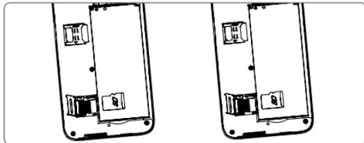
Deslize o suporte do microSD para a esquerda para desbloqueá-lo e levante-o. Coloque o cartão microSD no espaço respetivo, com os contactos dourados virados para baixo. Em seguida, baixe o suporte do microSD e deslize-o para a direita para bloqueá-lo.
