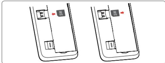
Coloque o cartão SIM com o chip virado para baixo e faça-o deslizar na ranhura. Certifique-se de que foi inserido corretamente. Para retirar o cartão SIM, carregue no mesmo e faça-o deslizar para fora.
