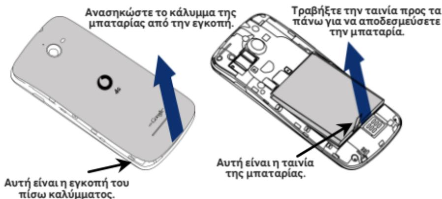
**Αφαίρεση του πίσω καλύμματος:** Με το αριστερό σας χέρι κρατήστε με ασφάλεια το τηλέφωνο και από τις δυο πλευρές του. Με τον δεξιό σας αντίχειρα σηκώστε το πίσω κάλυμμα χρησιμοποιώντας την εγκοπή.
