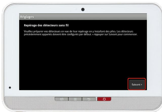
6. Cliquez **Suivant** sur l'écran **Localisation des détecteurs sans fil**. L'écran tactile va alors rechercher un détecteur pendant une durée maximale de 10 minutes.
